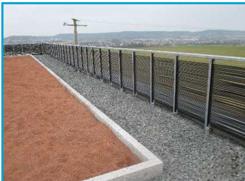
Recinzione assorbente con funzione di barriera visiva, ad es. per la rigenerazione di sistemi ad accumulo di ghiaccio o altre applicazioni (con tubi speciali in PE)
