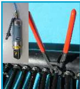
Pinza di crimpatura pneumatica o manuale con limitatore di pressione per schiacciare la fascetta stringitubo a un orecchio
