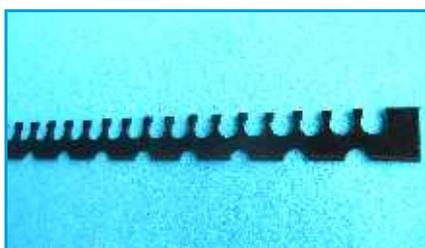
Piastra di fissaggio a clip in PE lunga 2 metri, accorciabile a misura. Si può infilare di piatto sotto il collettore e quindi metterla facilmente in posizione sollevandola di 90°. Distanza di posa ca. 60-80 cm. (N° d'ordine Turbo0.1)
