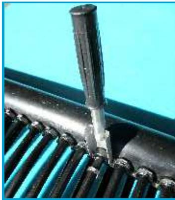
Se il montaggio non è stato eseguito correttamente, sfilare la fascetta stringitubo dall'ugello di raccordo in gomma con un'apposito attrezzo. Con lo stesso attrezzo usato per lo smontaggio estrarre l'ugello di raccordo in gomma, che non viene danneggiato e può essere riutilizzato più volte. Con una pinza speciale si può ridare forma alla fascetta stringitubo in acciaio inossidabile e riutilizzare anche questa.
