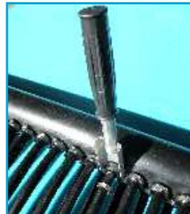
Attrezzo di smontaggio per allentare raccordi a innesto in caso di errori di montaggio (Risprinfo sicuro)
