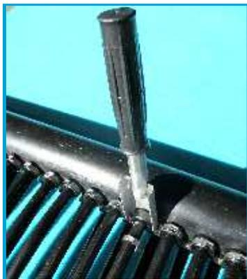
Falls Fehlmontage vorkommt, wird die VA Schelle mit der Demontagegabel vom Gumminippel abgezogen. Danach wird der Gumminippel mit der Demontagegabel in einfacher Weise aus dem Sammerrohr herausgedrückt. Der Gumminippel wird nicht beschädigt und könnte mehrmals wieder verwendet werden.
