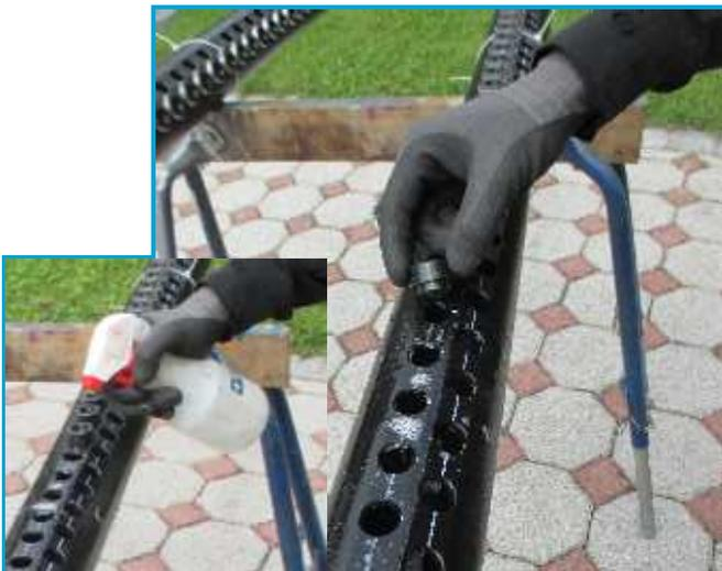
1. Anschlussöffnungen der Sammlerrohre mit Spüli einsprühen.      2. Gumminippel ansetzen und eindrücken.
