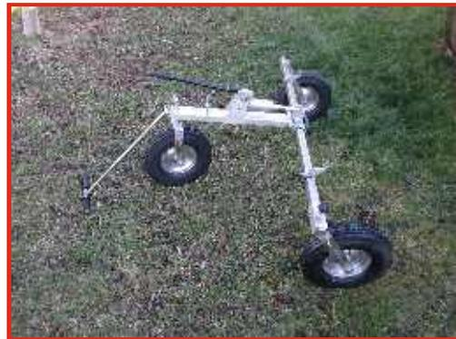
Geländeausführung, längere Variante + 25 cm mit großen Lufträdern D 420 mm für unwegsames Gelände.
