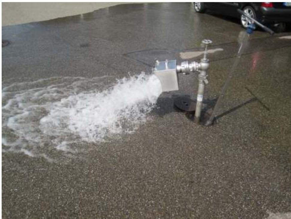
Spülstromgeometrie bei 5,5 bar statischem Eingangsdruck
