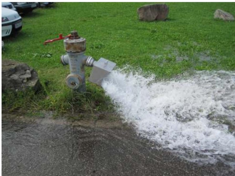
Spülstromgeometrie bei 6 bar statischem Eingangsdruck
