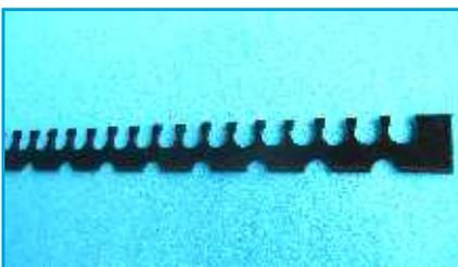
Rail PE, 2 m de long. Peut être passé facilement à plat sous le collecteur avant d'être redressé à 90°. Poser env. tous les 60-80 cm, (réf. Turbo0.1).
