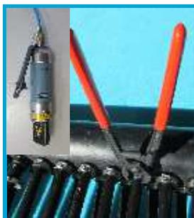
Pince à sertir pneumatique ou manuelle avec butée pour serrer les colliers à une oreille. Outil à fourche pour desserrer le connecteur en cas d'erreur de montage.
