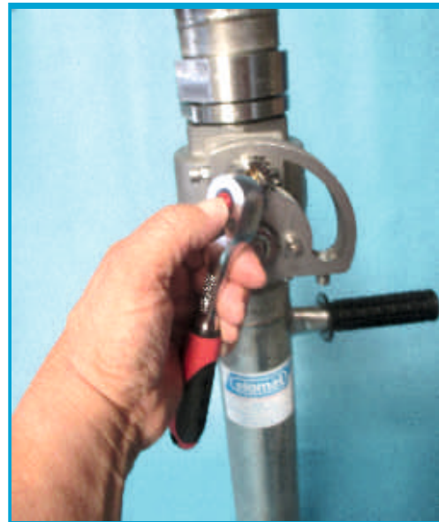
Abnehmbare Handratsche gegen unbefugte Betätigung
