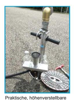
Ablagefläche für 2 Stück Laborgläser. Ebenso zurückklappbar.
