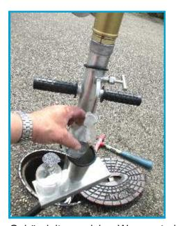
Gebündelter, weicher Wasserstrahl (Bleistiftstärke) am abflammbaren Probeentnahmeventil. (Probeentnahmeventil auch separat erhältlich: #Proha)
