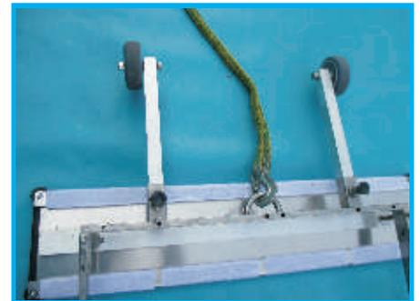
Praktische Öse zum evtl. Einhängen von Geräte-Seilsicherung oder zum Hochziehen.
