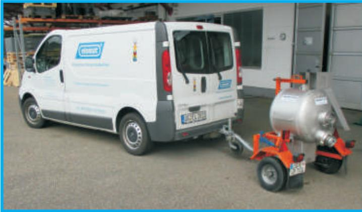
Optional mit orangenem Geräteträger mit TÜV-Abnahme, bis 80 km/h, StVZO einsetzbar.
