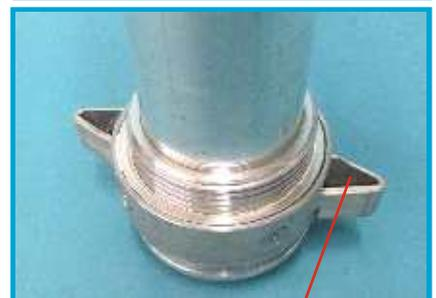
Sicherheitsstandrohrfuß mit Gummi-Rutschhemmung
