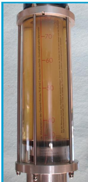
Evtl. Wassertrübung ist durch den Vergrößerungseffekt im Schauglas gut einsehbar.
