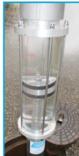
Autom. Selbstreinigungseffekt der Schauglasinnenseite während des Betriebs mittels Gummiringen am hochfahrenden Messkolben (Scheibenwischereffekt)
