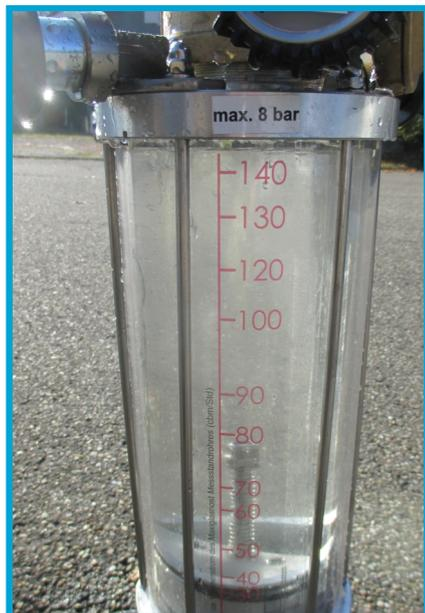
Große Skala von ca. 30-140 cbm. Aussagefähige Messung mit geringen Toleranzen zur Beurteilung der Hydrantenleistung (kein Präzisionsmessgerät).
