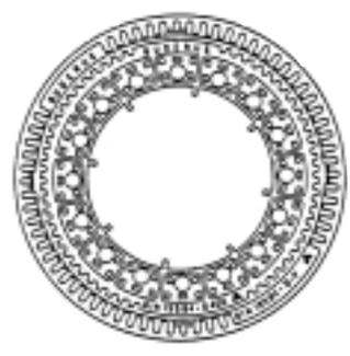
oder Anwendung zum Beispiel für: Schachtabdeckung Klasse B 125 gemäß DIN EN 124/DIN 1229 mit 2 Aushebemuskeln (Steg), ohne Lüftungsöffnungen
