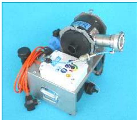
Basisgerät mit 6 Liter Tank, sowie Direkt-Zapfung aus Kanister möglich.
