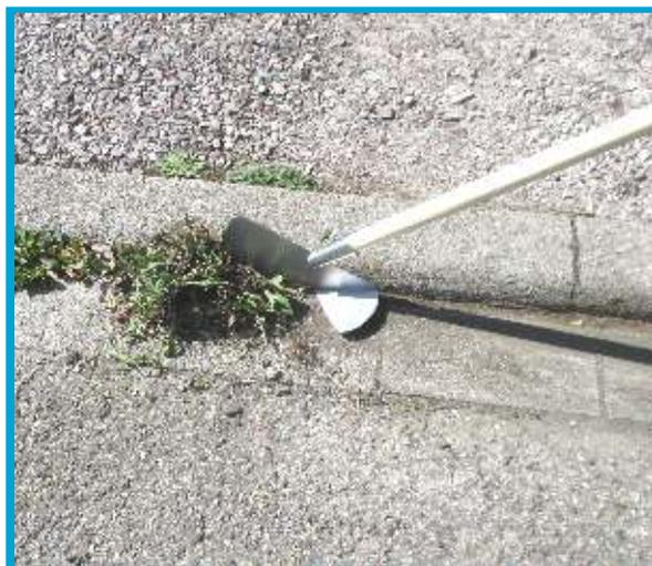
Ruckzuck können Gras und Ablagerungen abgeschabt werden. Schnittleistung: ca. 3m/Min. Das Werkzeug schält schon mit wenig Druck nach vorne, auch hartnäckige Büschel mühelos ab. (Bei etwas Befeuchtung der Grasnarbe geht`s fast von alleine)
