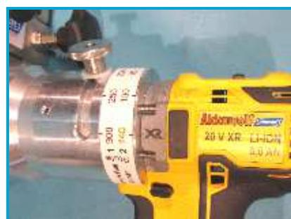
Einfache, mechanische Drehmomenteinstellung und Arretierung mittels Stelling und Feststell-Rändelmutter
