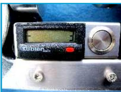
Inkl. elektronisches Zählwerk, addierend und subtrahierend, mit Reset-Taste
