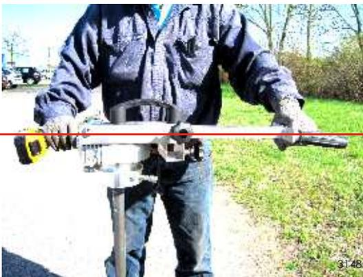
VA Teleskoprohr als Drehmomentstütze einsetzbar
