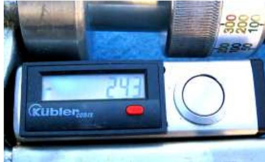
Elektronisches Zählerwerk, addierend und subtrahierend, mit Rückstelltaste, mit 5-Jahresbatterie.
