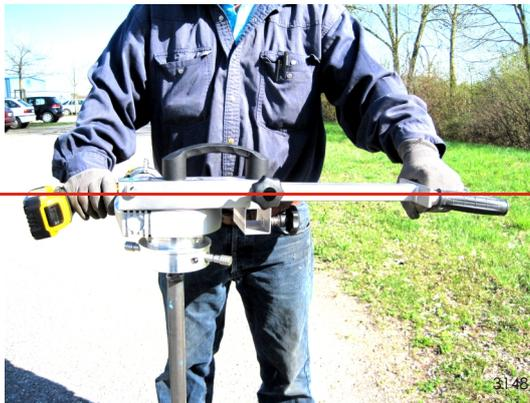
VA Teleskoprohr als Drehmomentstütze einsetzbar
