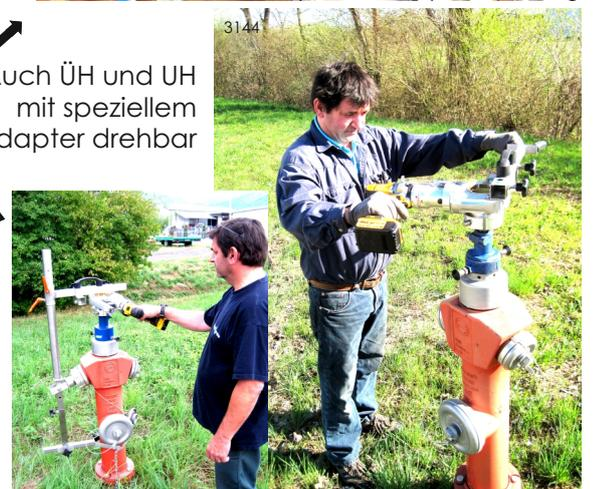
Mit und ohne Drehmomentstütze einsetzbar
