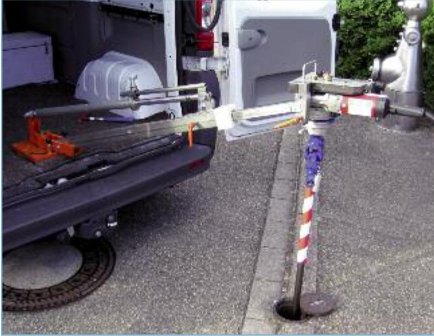
**Mit dem Teleskoparm sind vom Fahrzeug aus schwergängige Schieber zu betätigen.**
