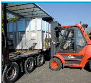
Gegenüber Betonschächten, nur ein Bruchteil an Gewicht. Je nach Ausführung nur zwischen 0,5 - 3t, leicht zu transportieren. Leichter Einbau auf der Baustelle, kein Schwerkran erforderlich, einfaches Handling
