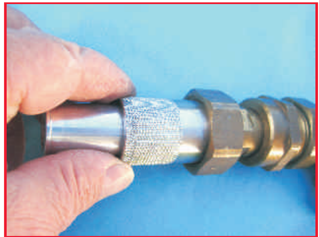
... oder bei nicht zurückschiebbarer Überwurf-Mutter ist die klemmende Dichtung herausfräsbar
