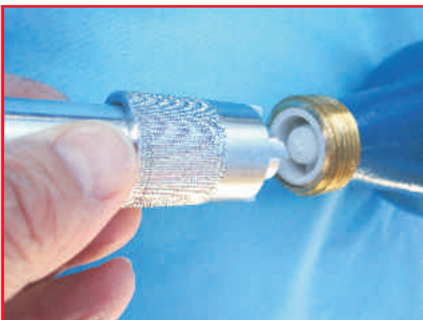
passt auch bei eingebautem RV im Zähler Qn2,5 / Qn6 / Qn10
