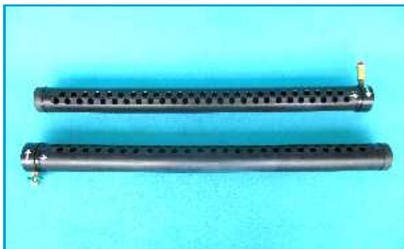
1 juego de tubos distribuidor / colector de PE. Según el formato hechos de tubo cuadrado de PE 60/60 mm o de tubo redondo, diám. Int. 125 o 160 mm. Conexiones para la alimentación y el retorno de forma individual según sea necesario
