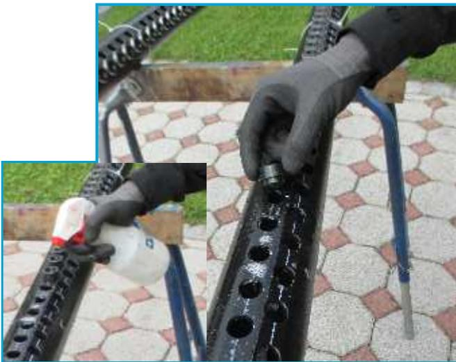
1. Pulverice jabón líquido en los orificios de conexión de los tubos colectores
