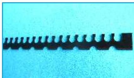
Listones de sujeción de PE de 2 m, recortables. Se puede insertar con facilidad debajo de la superficie del colector y luego girar 90° hacia arriba. Distancia de colocación aprox. 60-80 cm. (Ref.: Turbo0.1)
