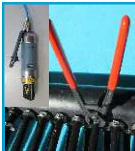
Crimpadora neumática o manual con limitación de presión fija para la sujeción de las abrazaderas una oreja. Horquilla de desmontaje para retirar los conectores de enchufe en caso de montaje incorrecto (fácil de reparar)
