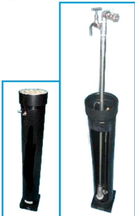
Abflammbarer Edelstahl Probenahmeahn
