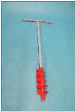
Taladro de tierra de 120 mm de diámetro para la fabricación de cimientos de hormigón. Se puede comprar o alquilar gratuitamente
