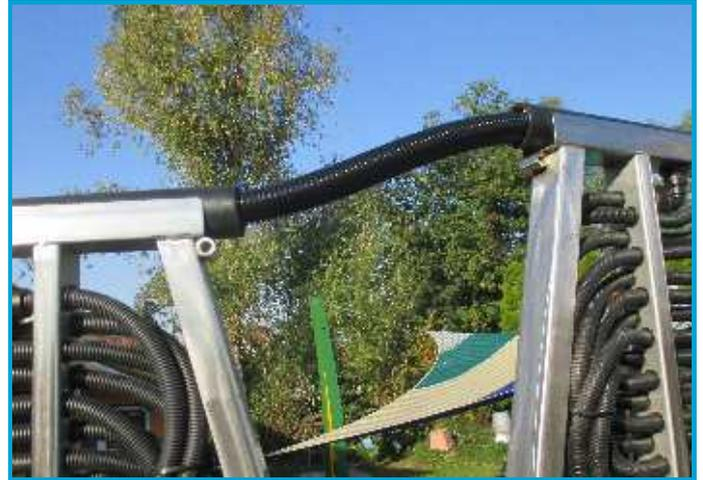
I tubi di raccordo flessibili permettono di variare l'altezza in funzione del livello e della conformazione del terreno.
