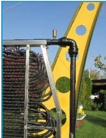
Lo stesso vale per il raccordo di ritorno, che corre parallelamente sul retro del montante tubolare. Anche la valvola di aerazione e sfiato è posizionata sempre nel punto più alto perché girevole.
