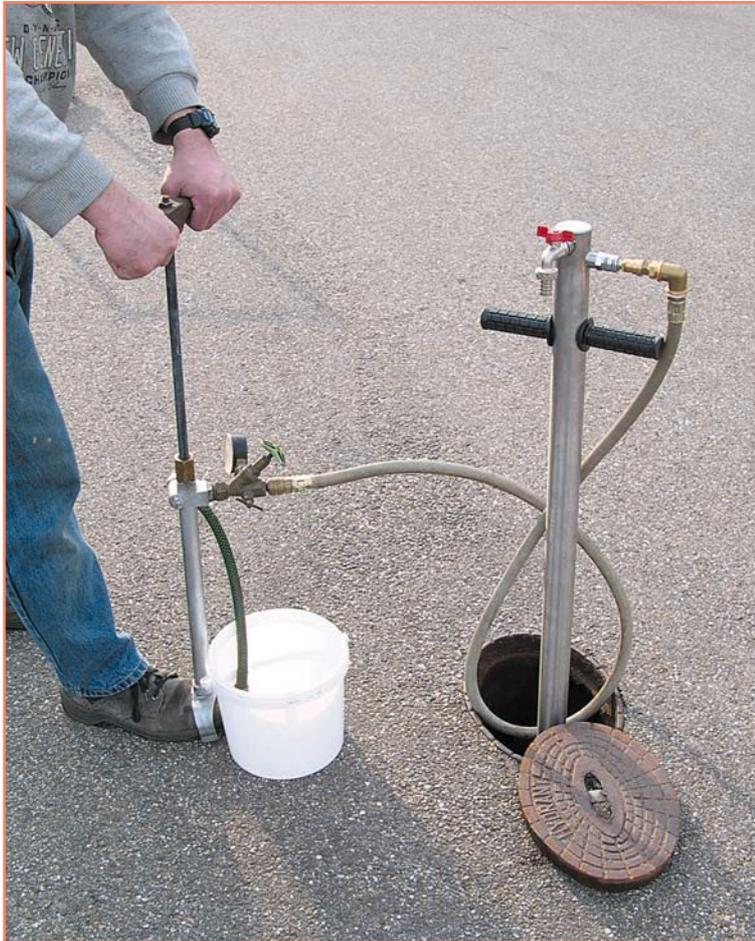
easypress in Kombination mit Hochdruckstandrohr aus Edelstahl von Elomat.
