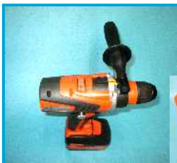
Armaturenantrieb, Drehmomentstabilisierung per Hand
