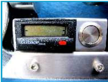
Standardmäßig elektronisches Zählwerk, addierend und subtrahierend, mit Reset-Taste.
