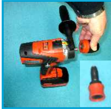
Röhm-Schnellwechsel Bohrfutter, oder Bithalter aufsteckbar.
